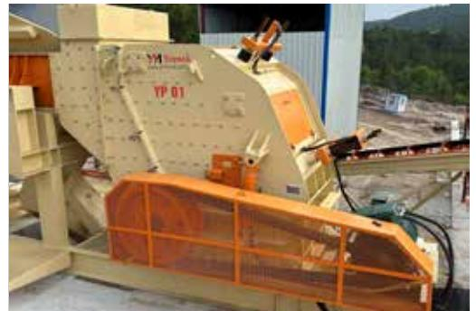
Les concasseurs à impact primaires de la série YP sont utilisés comme concasseurs primaires pour écraser des matériaux tendres, moyennement durs et non abrasifs. La dimension du produit final écrasé peut être quelque peu contrôlée. Ces concasseurs, produits en plusieurs tailles différentes, sont entraînés par un moteur électrique via une courroie en V et une poulie.
