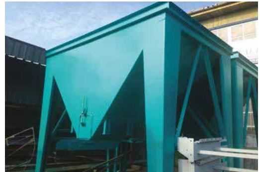
Les silos à agrégats de la série YAH sont conçus avec une structure modulaire, ce qui leur permet d'être fabriqués selon différentes capacités et quantités. Les couvercles des silos s'ouvrent et se ferment automatiquement grâce au piston pneumatique.
