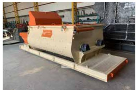
Les mélangeurs de la série YM de l'usine de stabilisation mécanique sont des mélangeurs conçus avec un double arbre horizontal et un type continu. L'homogénéité du mélange est assurée par leur grande taille et la qualité du mélange. Ils sont équipés de pulvérisateurs pour ajouter de l'eau au mélange.
