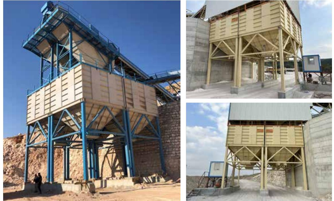
Les trémies de stockage de la série YH sont conçues pour que les produits provenant de l'usine soient empilés directement sur le camion. Elle se compose d'une trémie qui permet de stocker le matériau et d'un système de couverture qui s'ouvre et se ferme à l'aide de pistons pneumatiques. Il peut être fabriqué dans différents volumes et dimensions sur demande.
