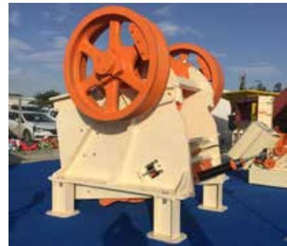
Les concasseurs à mâchoires de la série YJ sont principalement utilisés comme concasseurs primaires. Ce sont des concasseurs à compression qui écrasent les matériaux en les comprimant grâce à leur arbre excentrique. Il n'est pas possible d'obtenir des produits fins à partir de ces concasseurs, et le réglage de l'ouverture de décharge peut être ajusté. Ces concasseurs sont entraînés par un moteur électrique via une courroie en V et une poulie.
