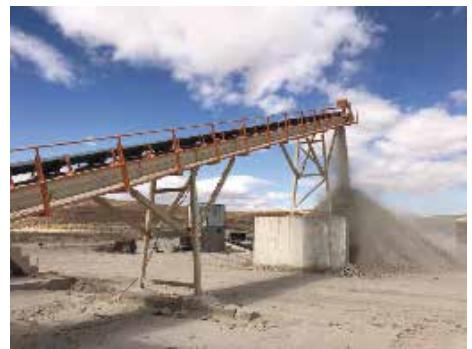
Les convoyeurs à bande de la série YB, conçus selon une structure modulaire, sont utilisés pour transporter les matériaux d'un processus à un autre dans une installation de concassage, ainsi que pour le stockage des produits finis. Ils sont fabriqués en différentes largeurs selon la capacité requise, et en diverses longueurs selon les besoins. Les convoyeurs à bande sont entraînés par un moteur électrique et un réducteur monté sur arbre via une courroie trapézoïdale et une poulie.
