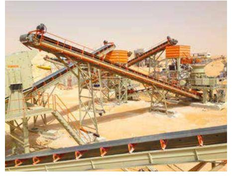
250 - 300 Tonne / Heure Installation De Concassage Et De Criblage Fixe
